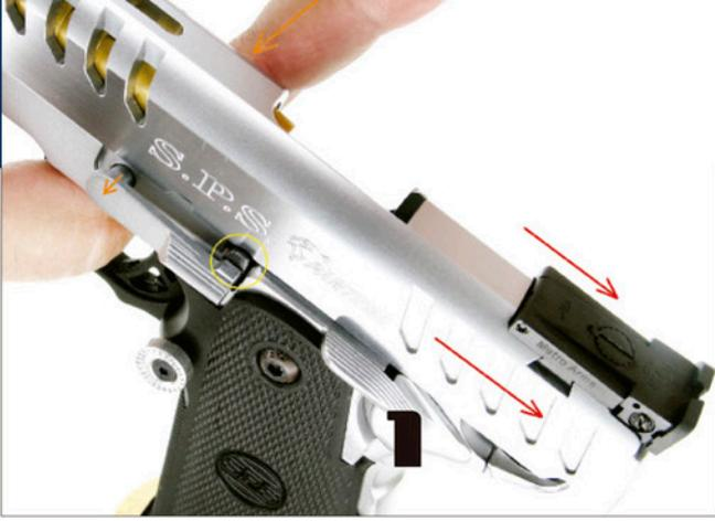
**1»** Retrasamos la corredera hasta coincidir su rebaje (en amarillo) con la palanca de retenida, para empujar su eje por el costado derecho y extraer la palanca por el izquierdo.
