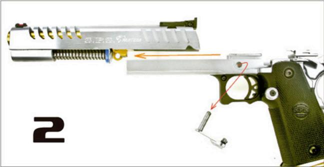
**2»** Deslizamos hacia delante para separar el conjunto de la corredera del armazón.
