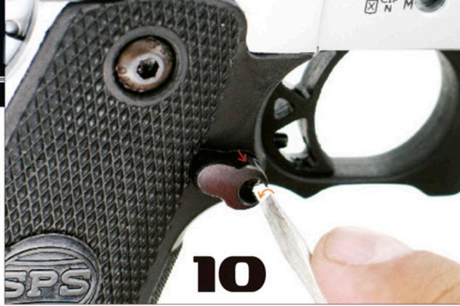
**10»** Para extraer el retén de cargador hay que presionarlo y deslizarlo un poco desde la izquierda. A su vez por la derecha con un pequeño destornillador vamos tanteando el lugar concreto donde nos permitirá girar el destornillador unos 90° en sentido antihorario; ocultará una pequeña pestaña y ya podremos extraer el retén.
