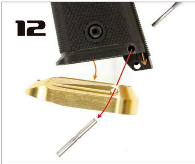
**12»** Ayudados de martillo y botador, deslizaremos y retiramos el pasador situado en el talón de la empuñadura. Una vez retirado nos permitirá extraer el Fannel O tolva para el alojamiento del vargador), y deslizar hacia abajo el bloque que contiene comprimido el muelle del martillo.
