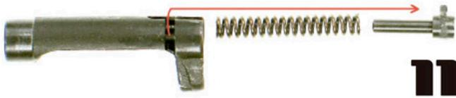
**11»** Extraído el retén de cargador, si ahora volvemos a girar el tornillo en sentido horario podremos separar sus tres componentes: Retén, muelle y tornillo.
